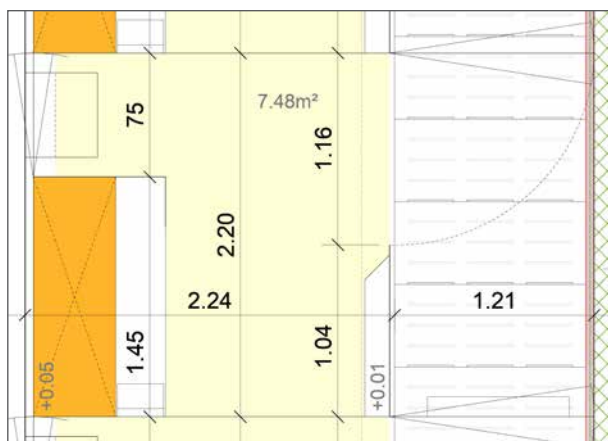
Grundriss Krieger AG Orange: Ferkelnest, gelb: Sauenliegebereich, weiss: Kotbereich
