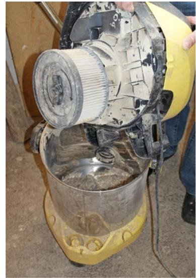
*Staubsauger mit Filter zum Reinigen.*
