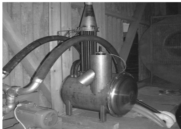
Der Vibrations-Absorber reduziert Vibrationen in der Milch- und Luftleitung.
