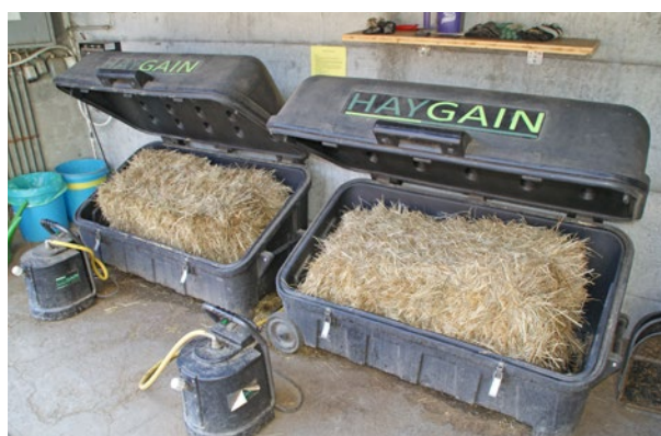
Attrezzatura per eseguire l'evaporazione sotto vuoto delle balle di fieno.
